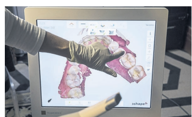
Die Firma Teamziereis aus Engelsbrand stellte einen Intraoralscanner samt Software zur Verfügung. Damit konnten vor Ort Gebisse von Teilnehmern gescannt und mit dem 3D-Drucker „live“ als Modelle gedruckt werden. Foto: HWK FR
