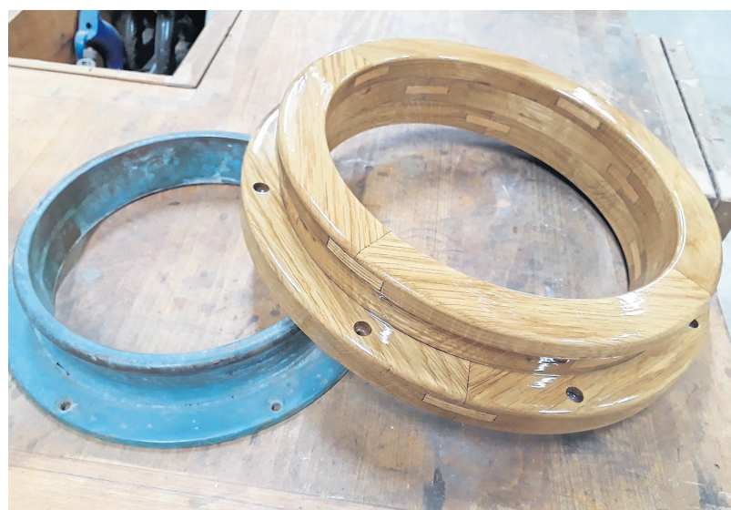
Zwei Mastkragen der Yacht: der eine von Till Huwer neu aus Eichenholz gefertigt, daneben zum Vergleich ein alter aus Bronze.
